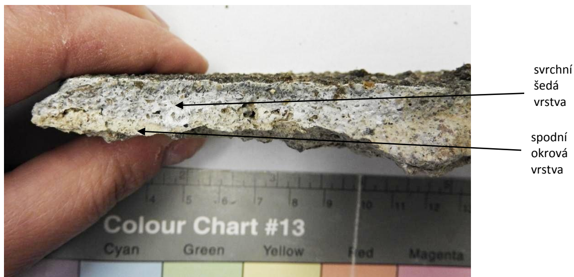
obr. 6 Lom vzorku 2 s vyznačenými dvěma omítkovými vrstvami
