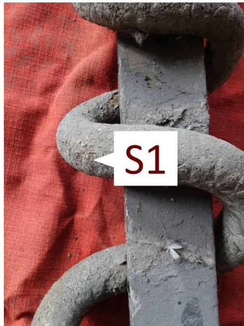
Obr. 5: Místo odběru vzorku S1 odebraného z těla hada krucifixu (foto zadavatel)
