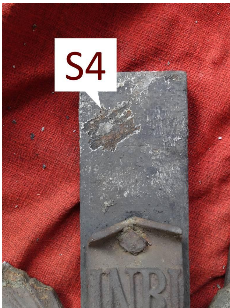
Obr. 11: Místo odběru vzorku S4 odebraného z břevna kříže (foto zadavatel)
