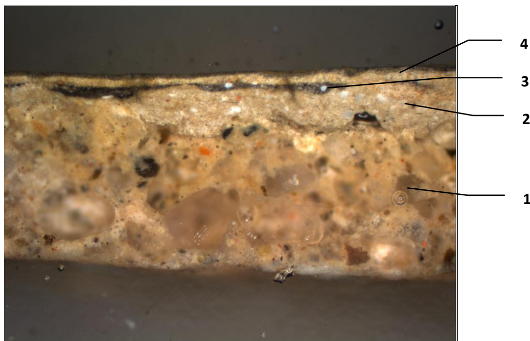
Obrázek 8: Vzorek 339/89-18, stratigrafie povrchových úprav, odražené bílé světlo, hrana snímku cca 4 mm
