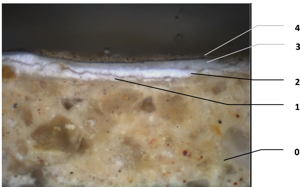
Obrázek 4: Vzorek 337/99-18, stratigrafie povrchových úprav, odražené bílé světlo, hrana snímku cca 2 mm
