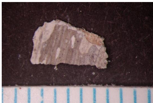
Obrázek 3: Vzorek 337/99-18, makrosnímek vzorku, dílek měřítka odpovídá 1 mm
